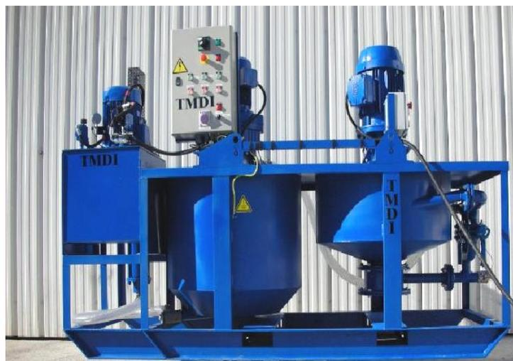
**Presse d'injection avec inverseur automatique**
