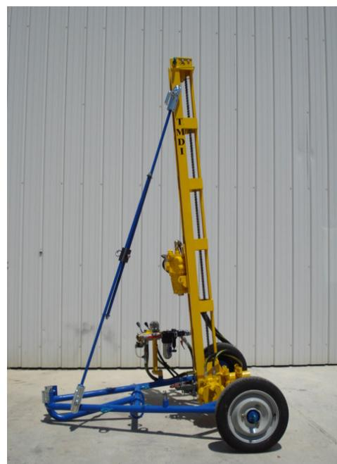
Pupitre de commande avec vanne de décompression, régulateur, vannes de fonctionnement du moteur et du Marteau T28.
